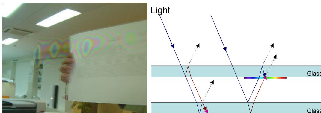
Согласно п. 4.1.6.3. "Проект межгосударственного стандарта. Стеклопакеты клееные строительного назначения. Технические условия" – На стеклопакете допускаются параллельные радужные или концентрические полосы (явление интерференции) видимые под углом менее 60° к плоскости стеклопакета.
