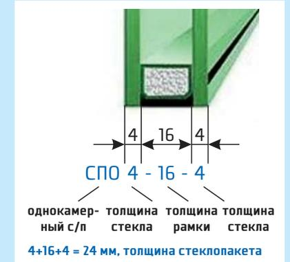
Рисунок №2 (Конструкция однокамерного стеклопакета)
