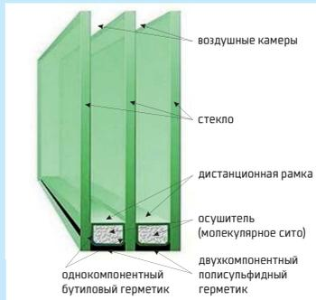
Рисунок №1 (Конструкция двухкамерного стеклопакета)
