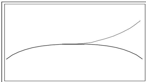
Рис. 2. Пример разрушения стекла в пакете, изготовленном с использованием «эластичного» краевого герметика (например, силикон).
